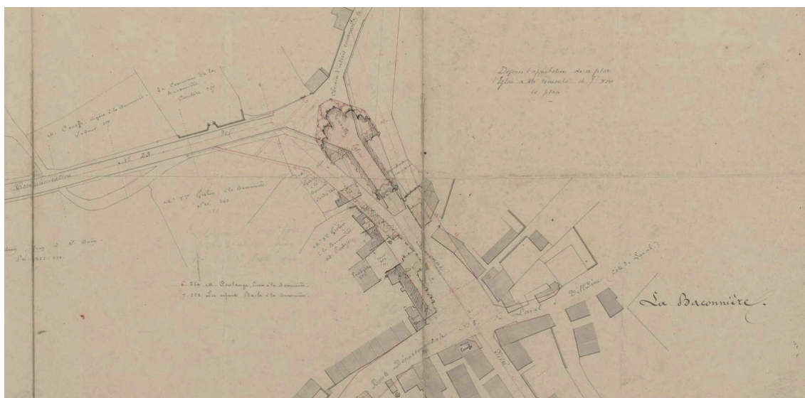
Plan de modification de tracé d'alignement montrant les corrections sur l'emplacement de l'église, 1864. Il est inscrit «Depuis l'approbation de ce plan, l'église a été remontée de 5m.» Source : AD 53, 2 NUM 100/18.
